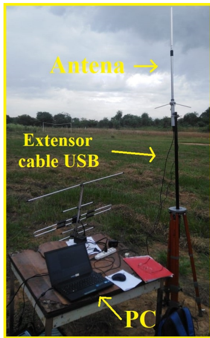
Fig. 28: Set de prueba segmento terrestre UHF basado en SDR portátil. Fuente: Elaboración propia.
