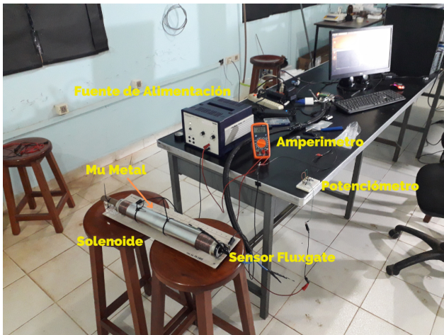
Fig. 11. Calibración del sensor en el laboratorio. Fuente: [17].
