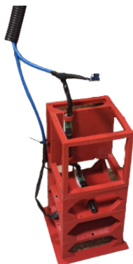
Fig. 14: Torre impresa en 3D para la unidad de recolección de datos. Fuente: [17].
