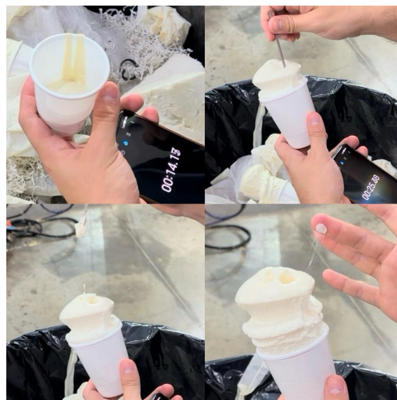
Figura 1: Determinación empírica del tiempo de hilo mediante observación de la formación de filamentos en una muestra de espuma PIR.
