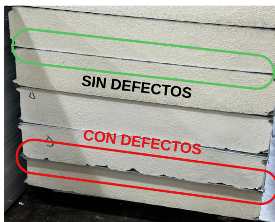
Figura 3: Visualización típica de defectos por espumado incorrecto.
