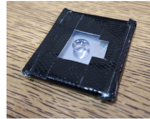
Figura 4: Centellador con recubrimiento y apertura para SiPM. Fuente: [Imagen propia]
