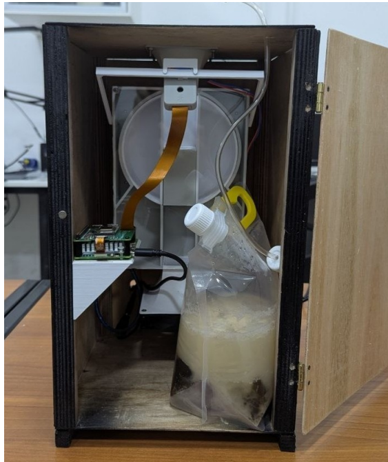
Figura 9.1: Trampa en la caja protectora con la puerta abierta, mostrando la disposición interna de los componentes. Fuente: Elaboración propia.
