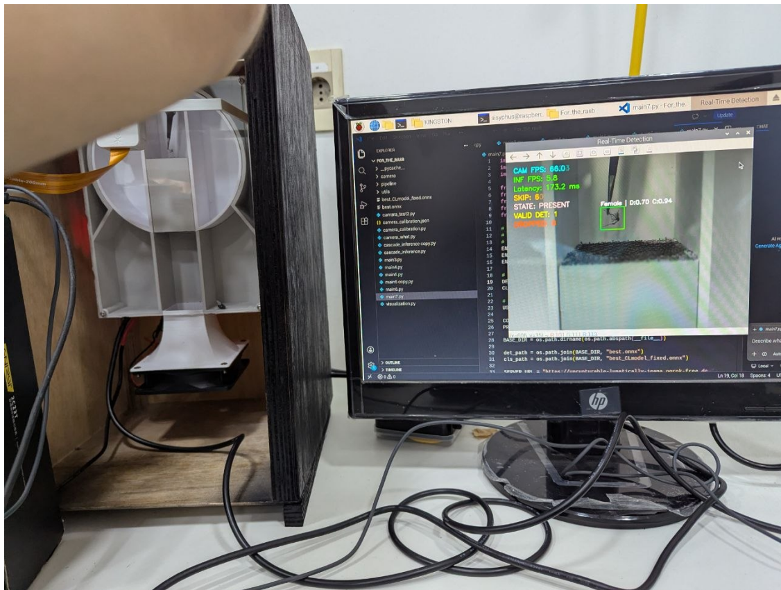
Figura 9.6: Trampa funcionando con un mosquito de prueba. El monitor conectado al Raspberry Pi permitió visualizar la detección en tiempo real. Fuente: Elaboración propia.
